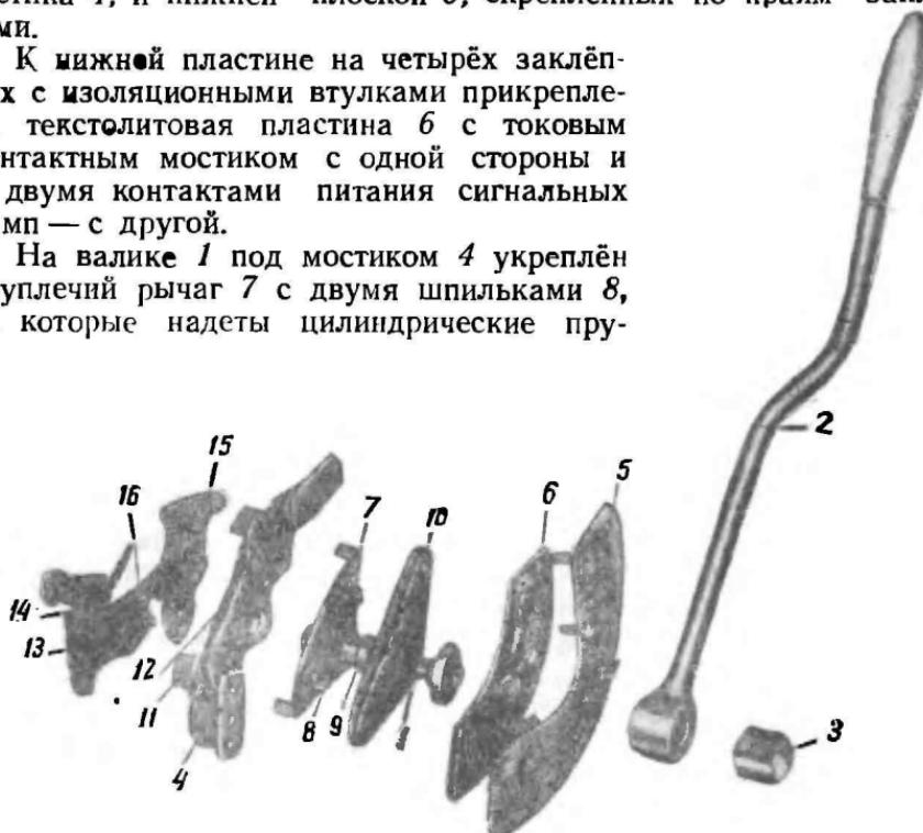
Фиг. 33. Переключатель сигнала поворота:
